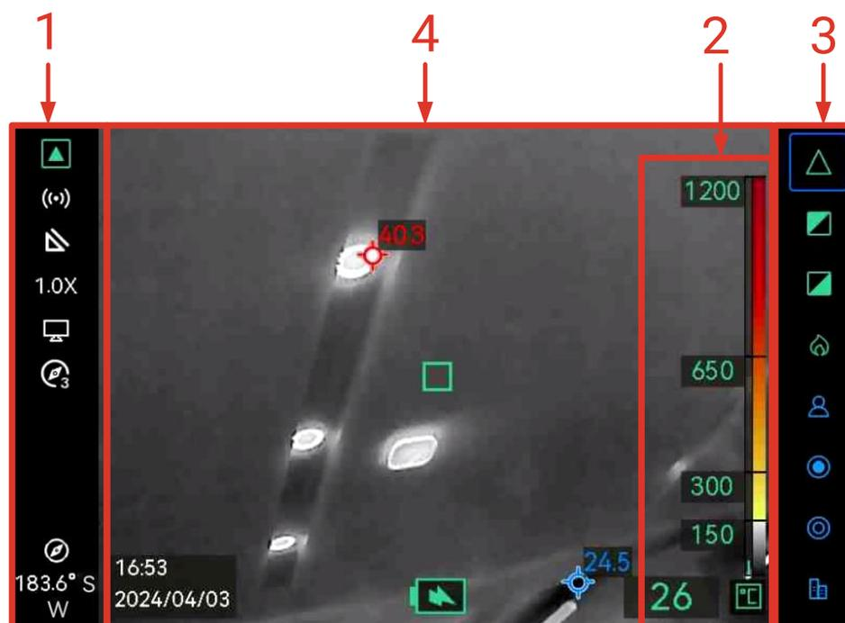
Figura 3-5 Interfaccia di visualizzazione live
